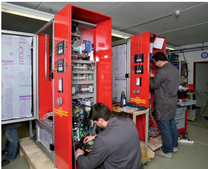
Сборка установки для плазменно-порошковой наплавки (РТА)
