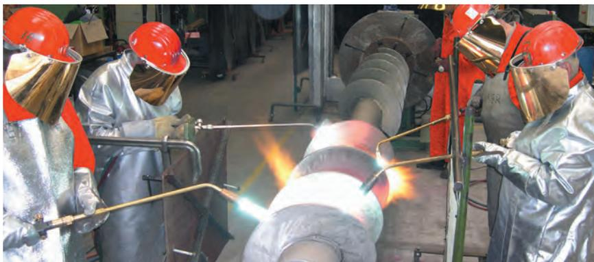
Проплавление порошкового сплава после напыления
