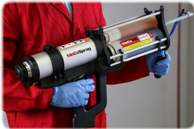
До начала подачи материала из картриджа, двухступенчатый триггер позволяет направлять поток воздуха сначала в сопло без подачи полимерных компонентов.
