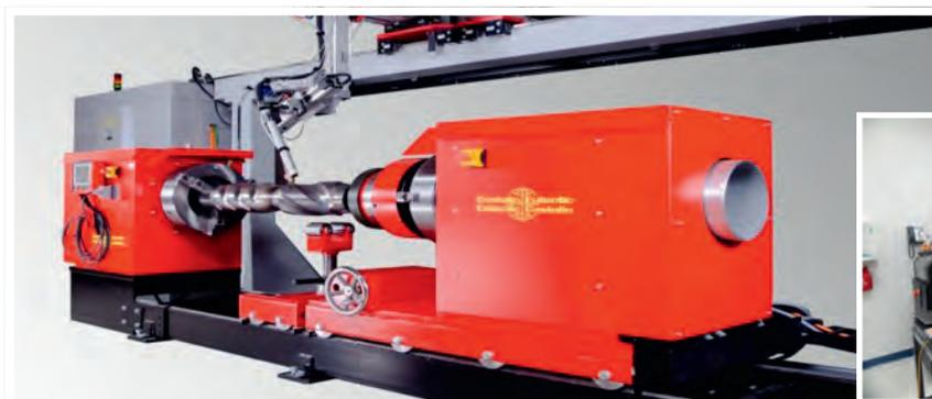
Система плазменно-порошковой наплавки (PTA)
