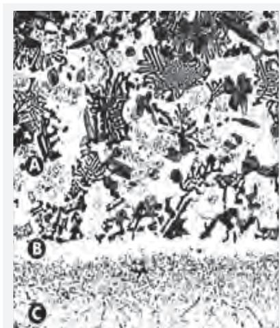
Металлургическое сцепление без смешивания сплава Eutalloy® со сталью (увеличено x 500).
