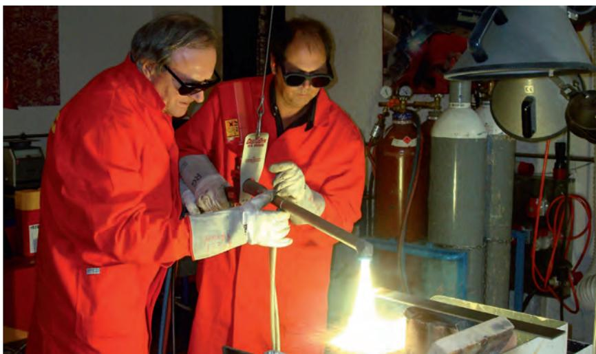
Обучение газо-термическому напылению с одновременным проплавлением
