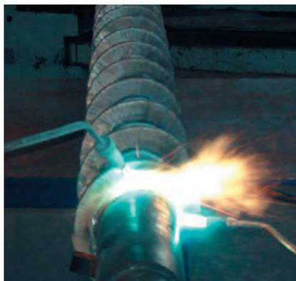
менты, подверженные различным видам износа. Eutalloy® - вид ацетилен-кислородных горелок для наплавки широкой гаммы порошковых сплавов. Используя технологию Eutalloy® можно получать покрытия толщиной от 0,01 мм до нескольких мм. Твердость наплавленного покрытия может варьироваться от 15 - 65 HRC, в зависимости от марки (химического состава) порошка. Покрытия получаются плотными и полностью однородными.
